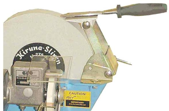
Legen Sie die Axt wie o.a.(Abb.). Justieren Sie den Schleifwinkel durch das Einstellen von **2**, stellen Sie die Schrauben fest und schleifen Sie. Haben Sie die eine Seite geschliffen, brauchen Sie nur die Axt umzudrehen und die andere Seite zu schleifen.
