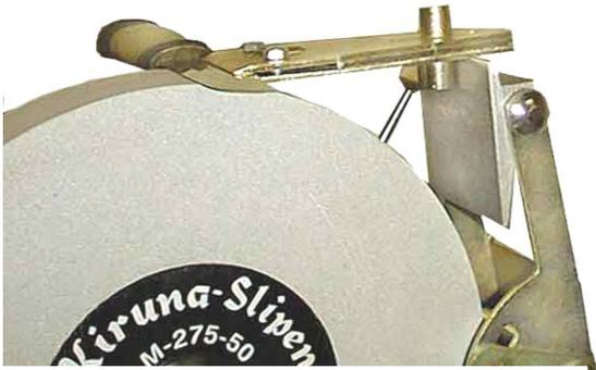
Befestigen Sie diesen Werkzeughalter über dem Schleifstein (s. Abb.). Schleifen Sie die eine Seite, drehen Sie danach beides, Messer und Werkzeughalter, eine halbe Drehung um und schleifen Sie die andere Seite.
