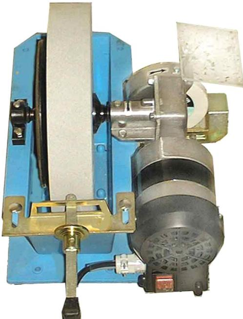
Zum Kiruna-Schleifstein gehört ebenfalls eine Vorrichtung, um den Schleifstein zu justieren. Beginnen Sie mit dem Justieren von einer Kante zur Mitte hin, danach von der anderen Kante zur Mitte, um Zerfaserung zu vermeiden.
