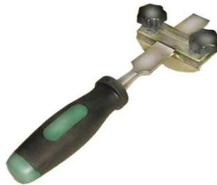
Dann schleifen Sie das Werkzeug. Achten Sie darauf, dass der Werkzeughalter zwischen der Stützplatte **1** und dem Schleifstein liegt, wie die Abb. zeigt.
