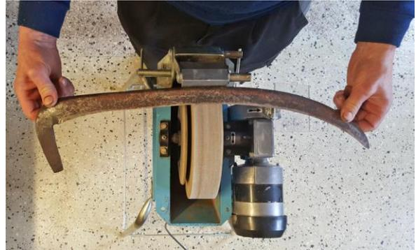
Wenn der Stein ist oval geworden. Sie können es leicht mit einer Farbe Schaber wiederherzustellen. Der Stahl sollte vorzugsweise aus Hartmetall hergestellt werden. Klar, dass die stein vor Beginn trocken ist.
