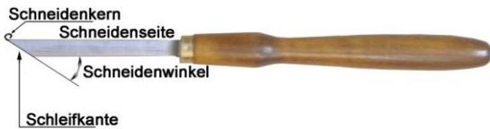
Am Ende des Schleifens hat sich der Schneidkern gebildet. Man kann diesen gut mit dem Finger fühlen oder sieht das am sich leicht kräuselnden Schleifwasser. Man muss immer zu diesem Schleifkern kommen, um eine scharfe Schneide zu erzielen.
