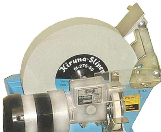
Nach dem Einstellen des gewünschten Schleifwinkels zieht man die drei Schrauben fest, um die Schleifstütze zu stabilisieren. Nun können Sie die Werkzeuge schleifen.
