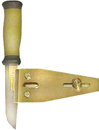
**Der Werkzeughalter** für Messer, Hufeisen, Eisbohrer und kurzen Schneiden, usw. Schrauben Sie das Werkzeug fest wie die Abb. zeigt, kontrollieren Sie, dass das Werkzeug in dem Werkzeughalter gerade liegt.
