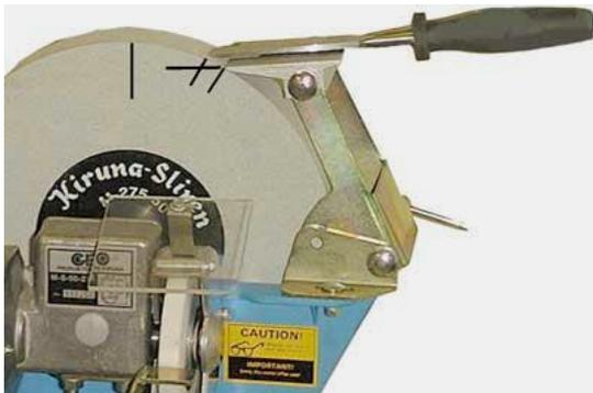
An der Schleifstütze finden Sie drei Schrauben, die Sie, wenn Sie wollen, leicht versetzen können. Zum Beispiel hat man mehr Platz, wenn man die untere lange Schraube so umdreht, dass sich die Schraubenmutter auf die Seite befindet, wo die kleine Schleifscheibe sitzt.
